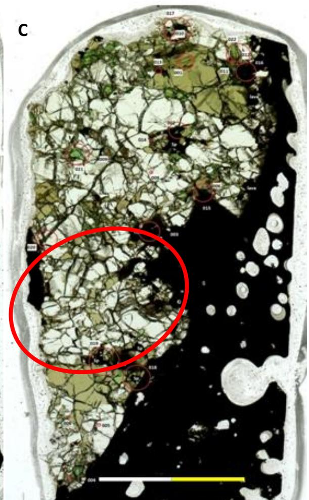
Figura 16: Imágenes obtenidas a través de escáner Epson, luz transmitida. Cada barra de escala mide 0.5 cm. (A) Textura protogranular en muestra PM27B-3.(B) Textura equigranular con contactos en  $120^\circ$  en los olivinos. (C) En círculo rojo pequeños cristales de Opx y Ol orientados en muestra PM27A-2.
