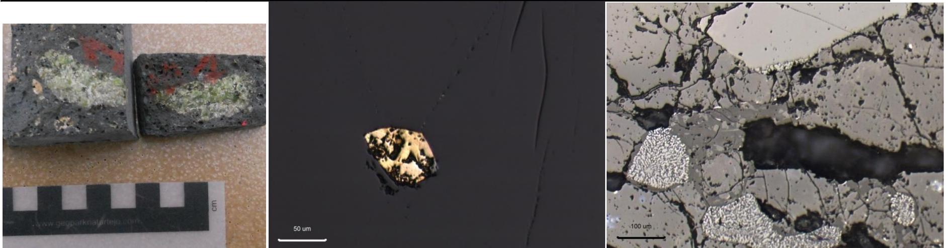
Figura Anexo 17: (A) Xenolito PM27B-1B en muestra de mano, barra de escala 1 cm. (B) Microfotografía obtenida a luz reflejada, sulfuro dentro de Opx. (C) Fuerte reacción de espinela en contacto con zona de infiltración de basalto
