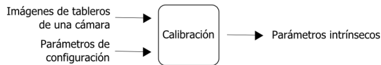
Figura 3.2: Diagrama para módulo de calibración.
