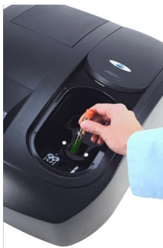
Figura 3.9 Instalación de vial con dilución de muestra de sedimento
