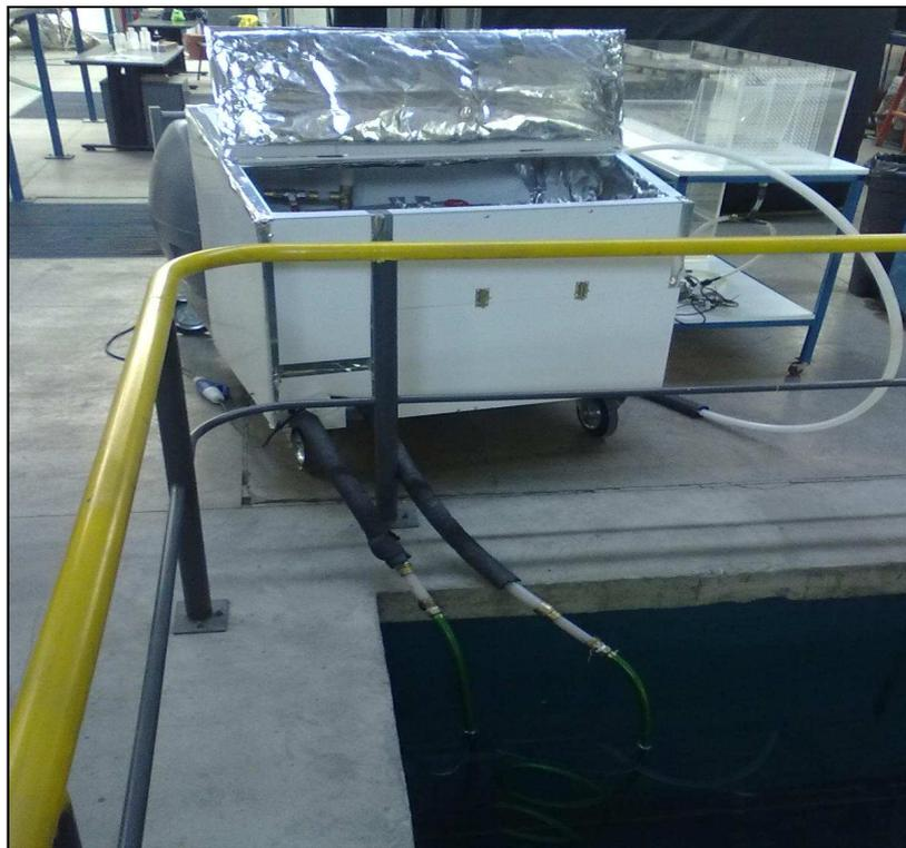
Figura 23. TRT midiendo el aporte de la bomba hidráulica en laboratorio de Hidráulica FCFM.
