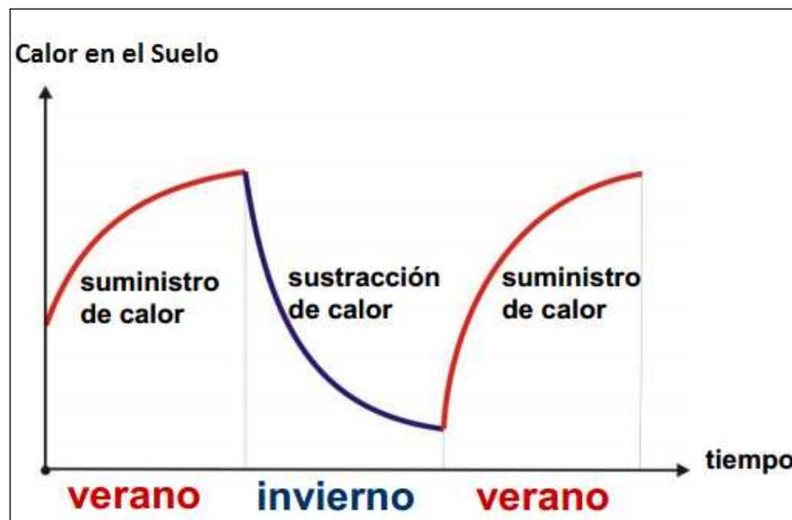
Figura 65. Inyección y extracción de calor en el suelo de un proyecto geotérmico. Wagner (2012, 7)
