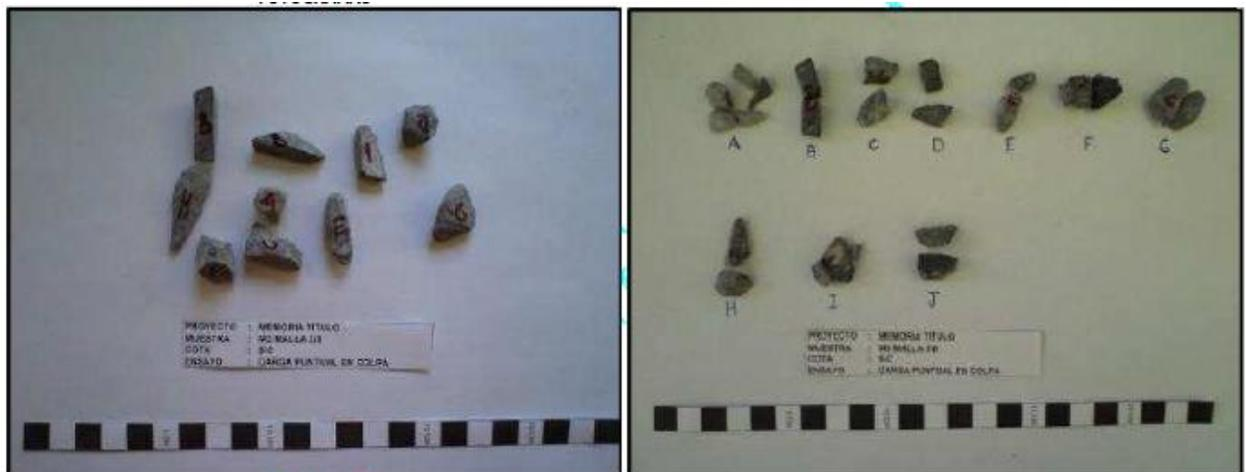
Figura 4.15: Fotografías antes y después de ensayo de carga puntual, partículas de 9.53 mm
