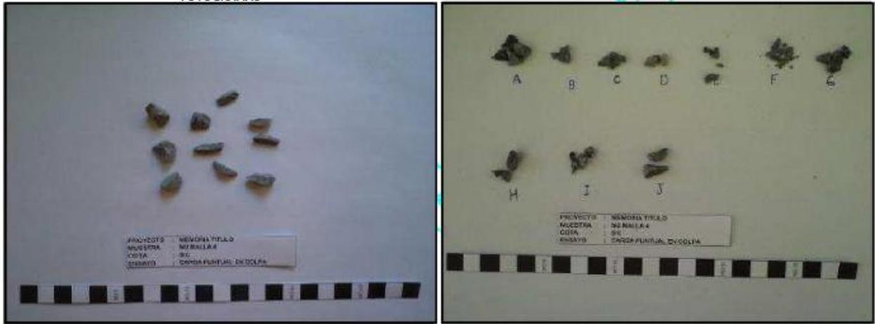
Figura 4.16: Fotografías antes y después de ensayo de carga puntual, partículas de 4.75 mm
