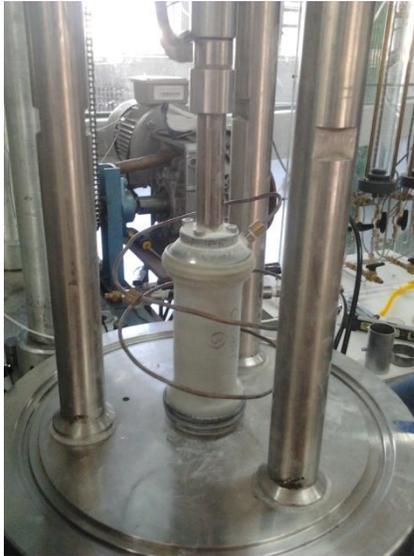
Figura 3.11: Confección probeta para triaxial de altas presiones
