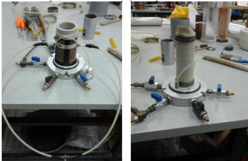
Figura 3.10: Confección probeta para triaxial de bajas presiones
