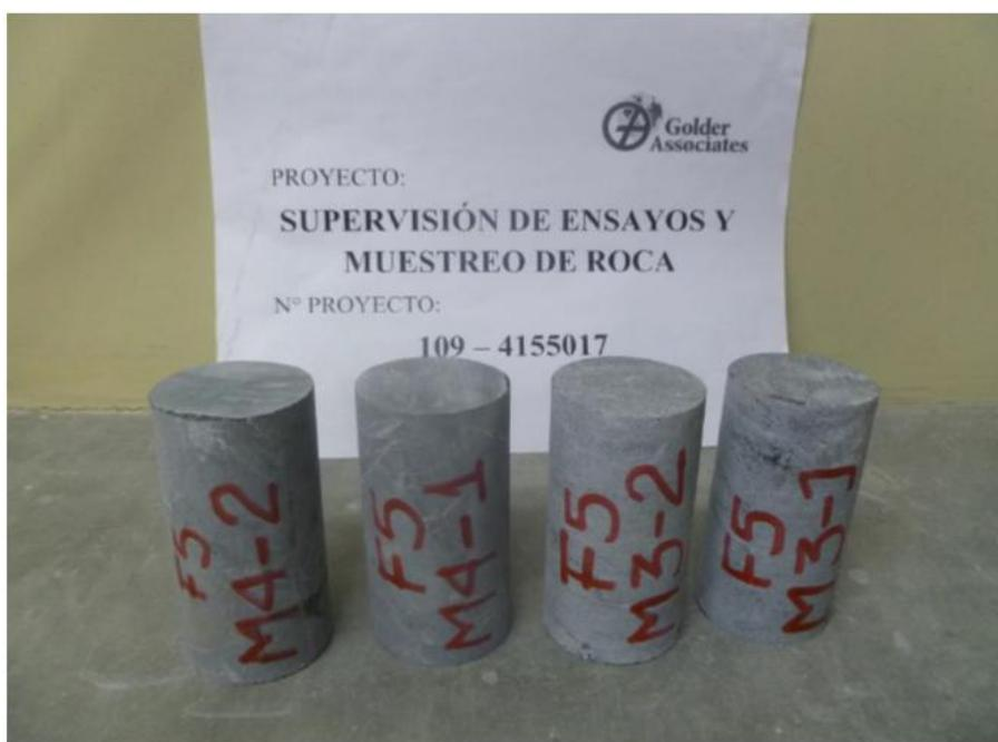
Figura 4.10: Testigos para ensayos de compresión uniaxial
