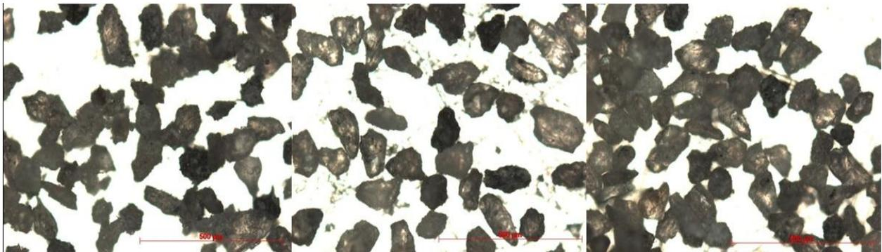
Figura 4.22: Partículas de material no ensayado, material H-3 post ensayo  $\sigma'_c=20$  [kgf/cm<sup>2</sup>] y material macro post ensayo  $\sigma'_c=20$  [kgf/cm<sup>2</sup>] entre mallas #140 y #200
