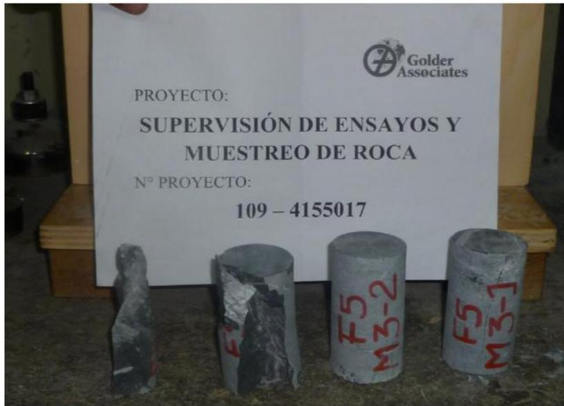
Figura 4.13: Testigos luego de ensayo de compresión uniaxial
