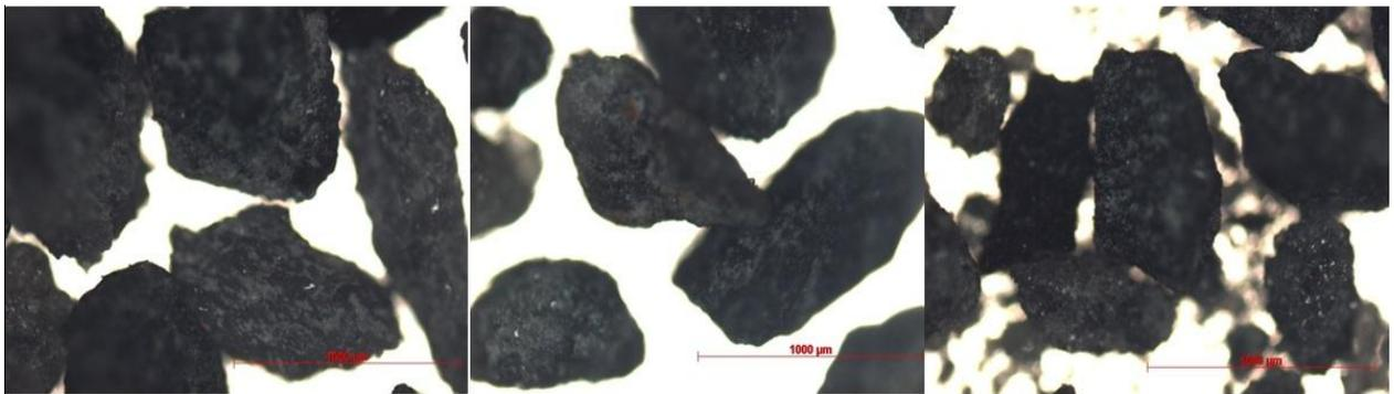
Figura 4.19: Partículas de material no ensayado, material H-3 post ensayo  $\sigma'c=20$  [kgf/cm<sup>2</sup>] y material macro post ensayo  $\sigma'c=20$  [kgf/cm<sup>2</sup>] entre mallas #20 y #40
