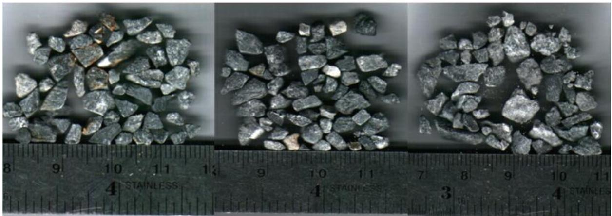
Figura 4.17: Partículas de material no ensayado, material H-3 post ensayo  $\sigma'_c=20$  [kgf/cm<sup>2</sup>] y material macro post ensayo  $\sigma'_c=20$  [kgf/cm<sup>2</sup>] entre mallas #4 y #10
