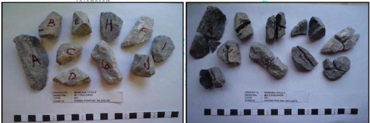
Figura 4.14: Fotografías antes y después de ensayo de carga puntual, partículas de 25.4 mm
