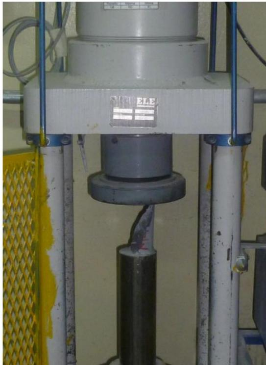
Figura 4.12: Equipo para ensayos de compresión uniaxial
