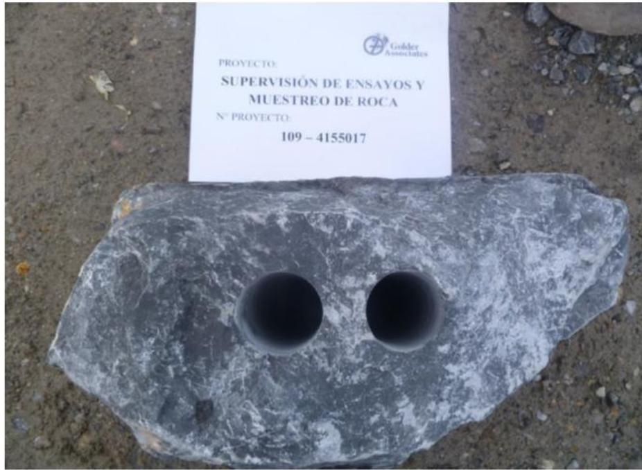
Figura 4.11: Roca (mármol negro perforada con diamantina) para ensayo de compresión uniaxial
