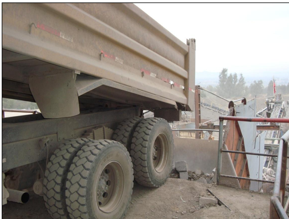
Figura 4. Vaciado de los cubos de hormigón en el chancador primario.
