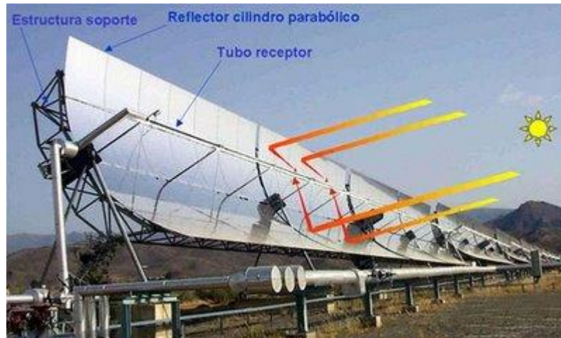
Figura 11: Diagrama de partes y concentración solar en colectores cilindro-parabólicos [17]
