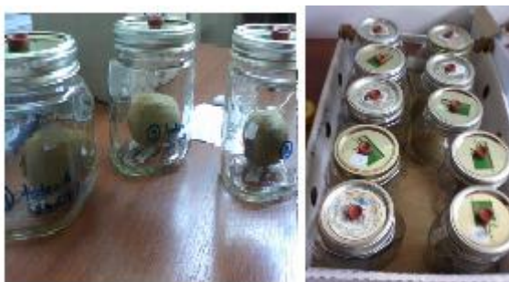
Figura 8: Recipientes de vidrio donde se colocaban los frutos para análisis de gases.
