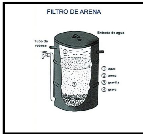
Figura 10.4: Filtro de Arena.
