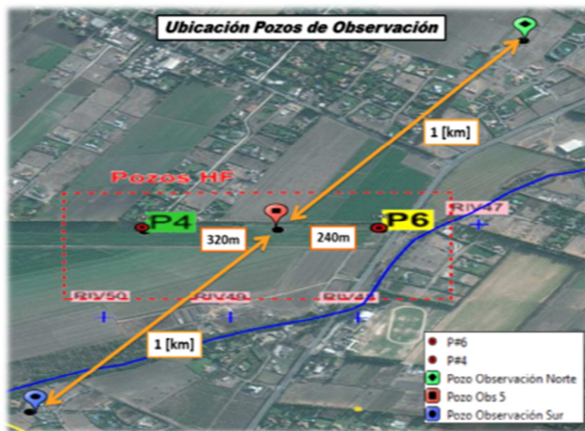
Figura 5.1: Ubicación de los pozos de infiltración P4 y P6, junto los tres pozos de observación.
