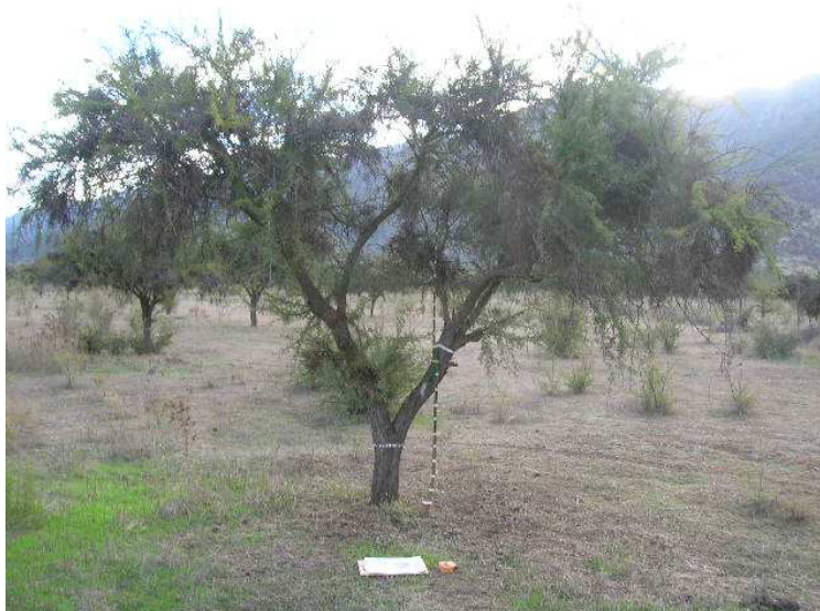
Figura 2: Medición en terreno de la altura y radio de copa, con coligüe previamente marcado cada 0.1 m.
