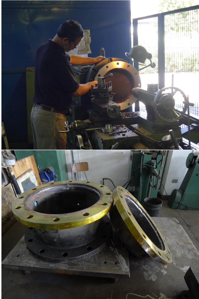
Figura 8.12: Trabajo en carcasa para evitar puente térmico
