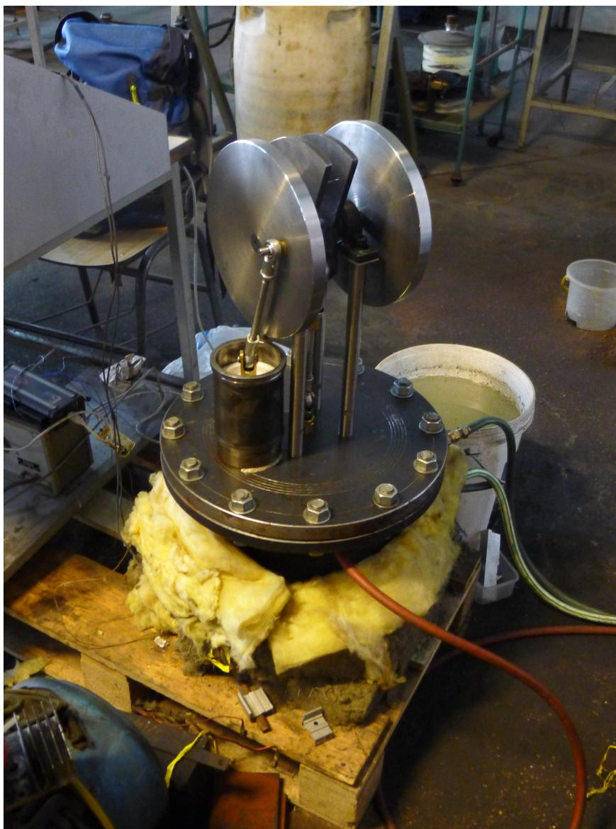
Figura 8.14: Aislación térmica en sección caliente
