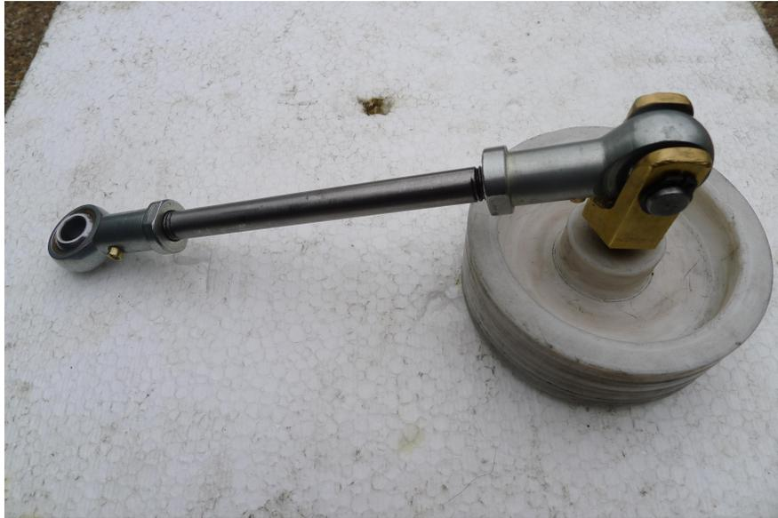
Figura 8.3: Detalle del conjunto biela-pistón de potencia.
