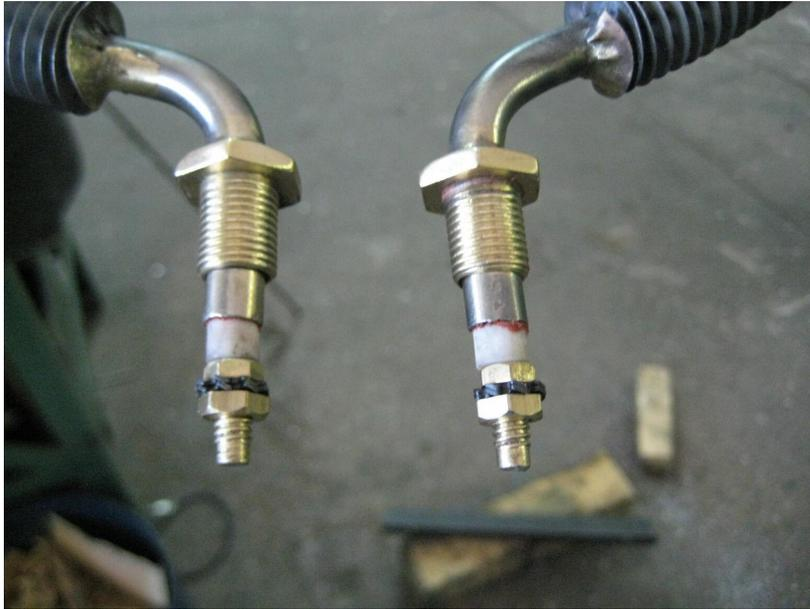
Figura 7.8: Detalle de las terminales de las resistencias aletadas utilizadas en el prototipo
