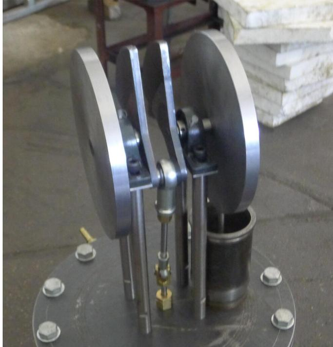
Figura 8.5: Balancines y volantes de inercia instalados en el motor.
