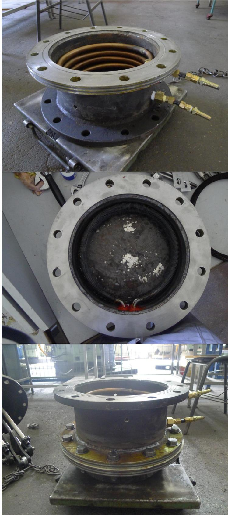
Figura 8.13: Montaje de intercambiadores de calor en carcasa.
