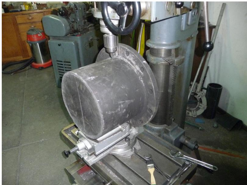
Figura 8.1: Imágen de carcasa mientras se le realizan algunas de las perforaciones para los conectores
