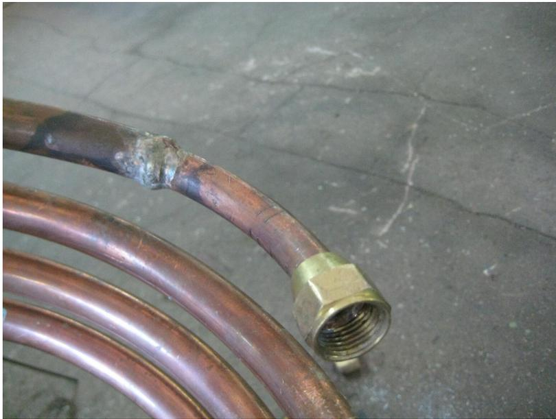
Figura 8.7: Detalle de la reducción en el extremo del IC frío.
