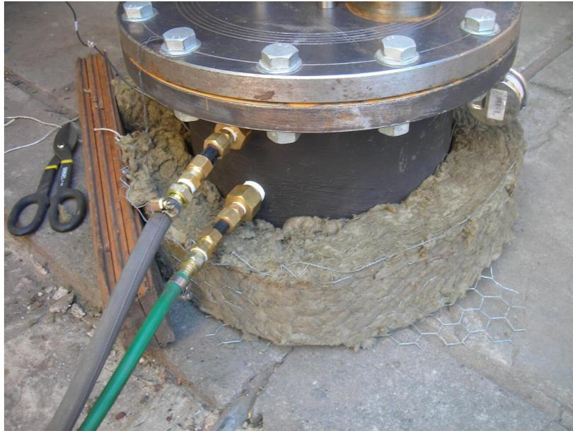
Figura 8.11: Prototipo con sección caliente aislada.
