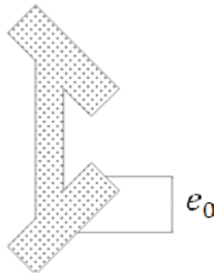
Figura III.16: Sección transversal con imperfección inicial
