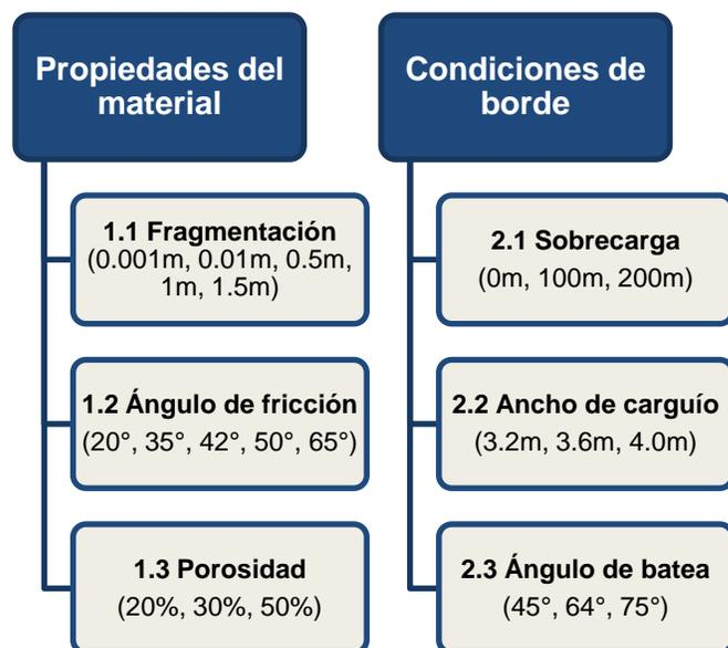
FIGURA 100: PARÁMETROS UTILIZADOS EN LAS SIMULACIONES DE TIRAJE AISLADO
