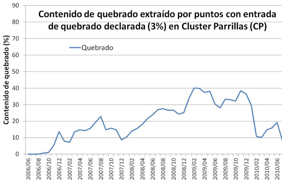
FIGURA 84: CONTENIDO DE QUEBRADO EXTRAÍDO POR PUNTOS CON ENTRADA DE DILUCIÓN DECLARADA CON EL CRITERIO DEL 3% ACUMULADO CLUSTER PARRILLAS
