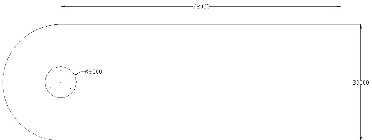
Figura 3.3: Dominio de simulación – El dominio rotatorio es circular con diámetro 8 m, mientras que el dominio estático es de 30 m de alto y 72 m de farfield . Medidas de la figura en milímetros.
