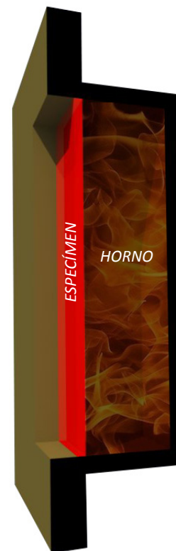
IMAGEN 7: Esquema explicativo del ensayo de resistencia al fuego. Fuente: Elaboración propia.
