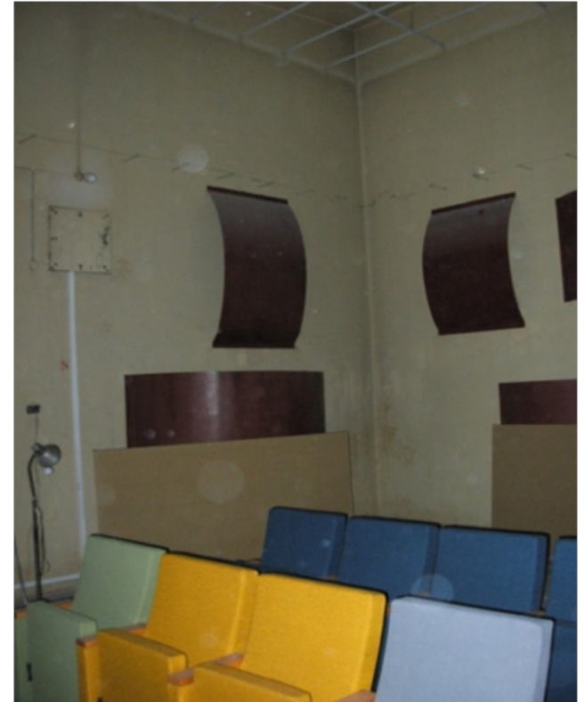
IMAGEN 4: Fotografía de la Sala Anecóica ubicada en el Edificio anexo del Idiem. En este caso se mide la absorción que efectúan un grupo de butacas.
