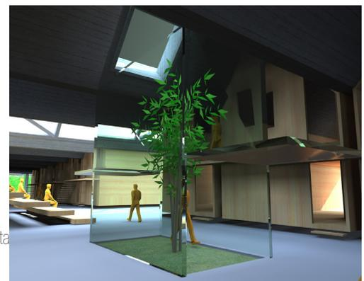
Imágenes digitales esquemáticas de "chimeneas" para la ventilación natural y ganancia de luz natural al interior. Fuente: Elaboración propia.
