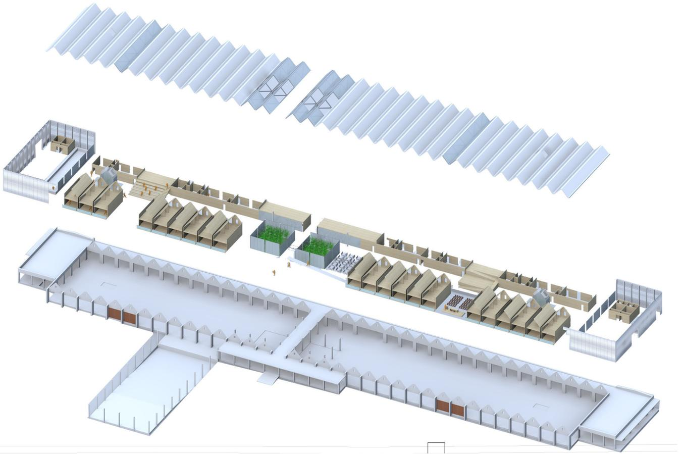
Esquema despiece. Relación de la estructura industrial y la intervención. Fuente: Elaboración propia.
