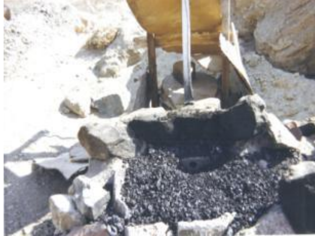
Fragua, sector encendido de carboncillo y calentado de herramientas
