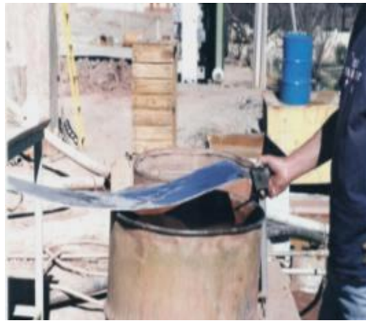
Planchas con mercurio, limpieza del mercurio que tiene atrapado el oro
