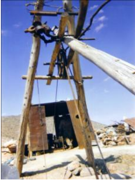
Pata de cabra con su sistema de poleas
