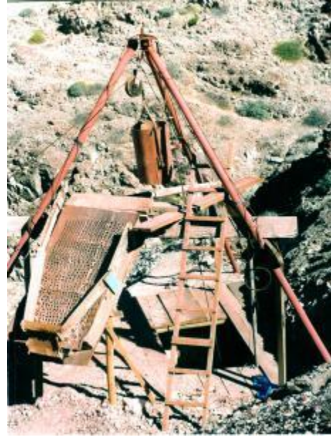
Pata de cabra, sistema de izaje y canal de harneo de mineral
