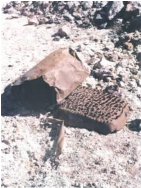
Harnero, capacho de metal y fierro o gallina para selección del mineral
