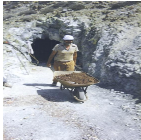
Traslado de material extraído desde socavón
