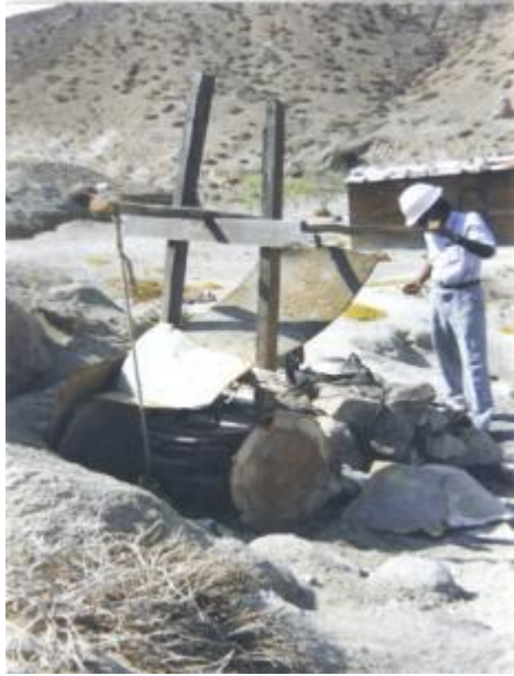
Fragua, se observa el sistema de soplido
