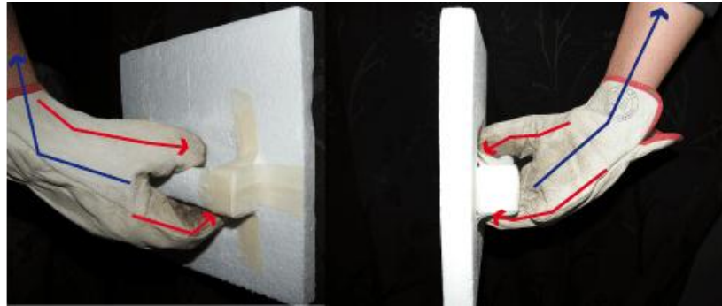
Ilustración 31 Esquema de tomas y distribución de fuerzas en el Agarre Palmar. Elaboración Propia.
