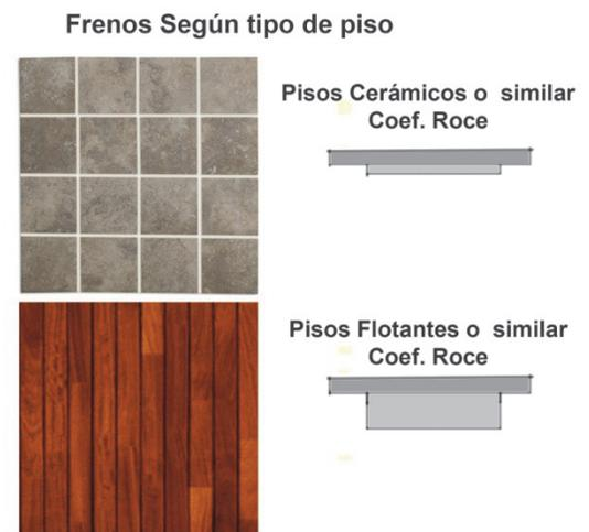
Figura 27. Espesores de la goma de freno según tipología de superficie. Fuente elaboración propia
