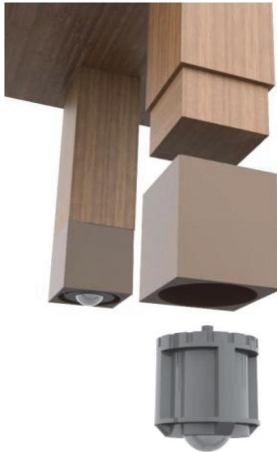
Figura 30. Visualización 3d módulo y pieza de unión para mobiliario de madera con patas. Fuente elaboración propia
