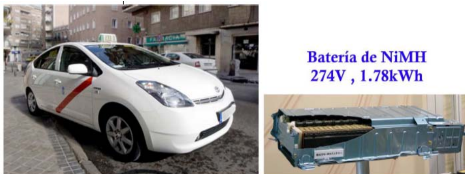
Figura 7: Batería NiMH y automóvil ejemplo que la utiliza (Amarilla, 2009 [12])
