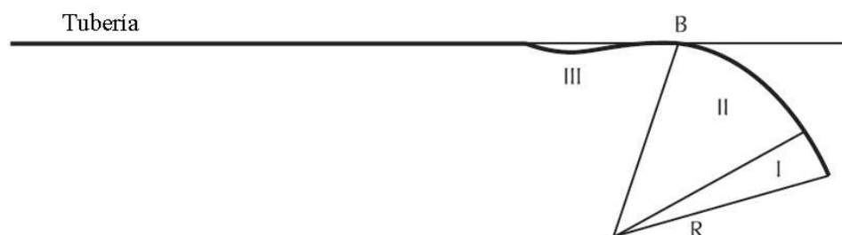
Figura 4.28: Vista en planta del modelo de Wang y Yeh (1985) (O'Rourke y Liu, 1999)
