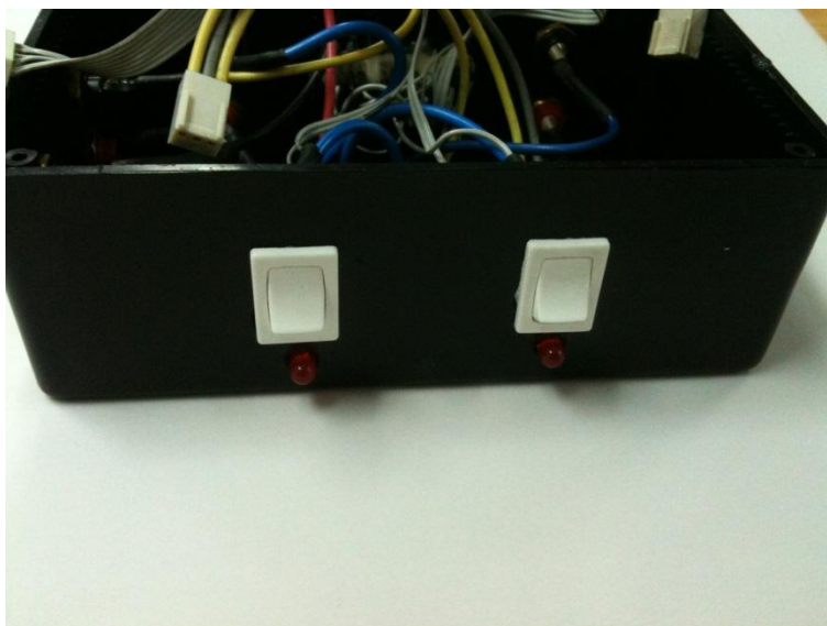
Figura 7.8. Interruptores con LED para activar el sistema.
