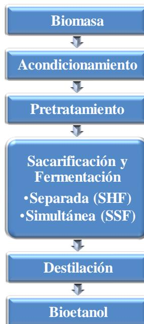
**Figura I-8: Esquema de producción de bioetanol de segunda generación.**
