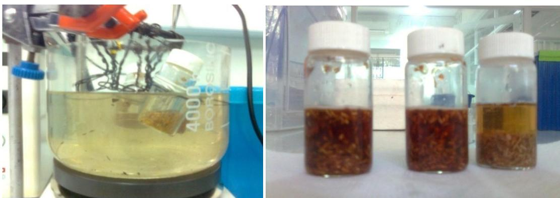
**Figura II-1: Pretratamiento. Derecha: montaje del pretratamiento en el baño termorregulado. Izquierda: viales luego del pretratamiento con PIL y control negativo, respectivamente.**
