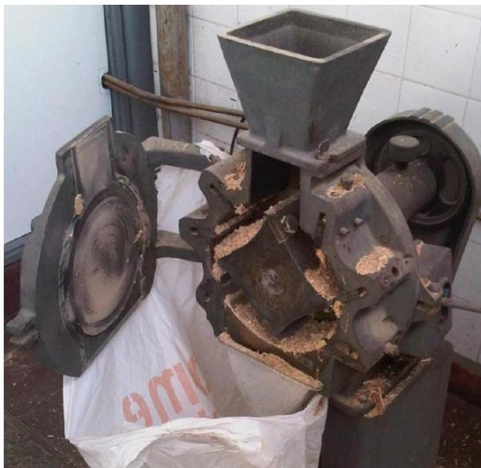
Figura G-1: Molino utilizado en tritución de eucaliptus.
