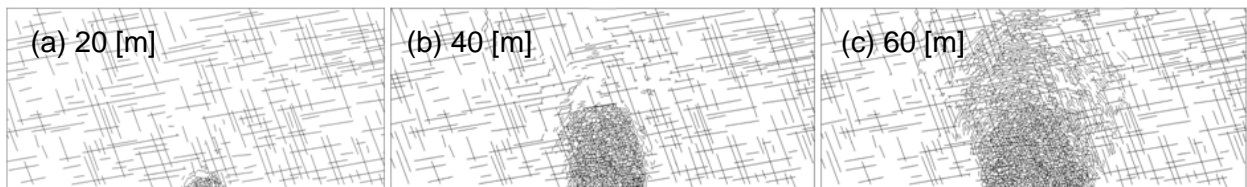
Figura 2—5: Simulación de la propagación del hundimiento usando una técnica híbrida – ELFEN. En cada etapa se indica el ancho del undercut , (a) 20 [m], (b) 40 [m] y (c) 60 [m] (Vyazmensky et al. 2007).
