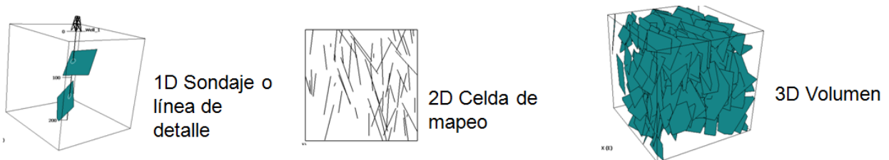
Figura 2—24: Dimensiones del espacio en la que se mide la intensidad de fractura de un DFN (Elmo 2011).
