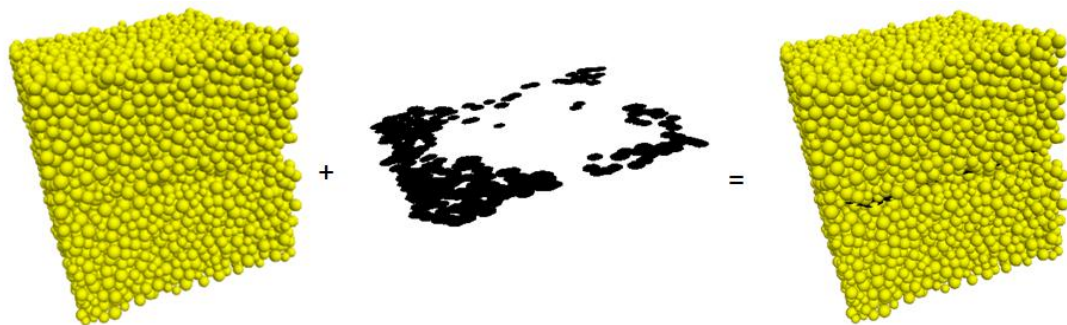
Figura 5—19: Muestra de roca sintética y daño en los contactos (en negro se presentan los contactos que fallan por corte).
