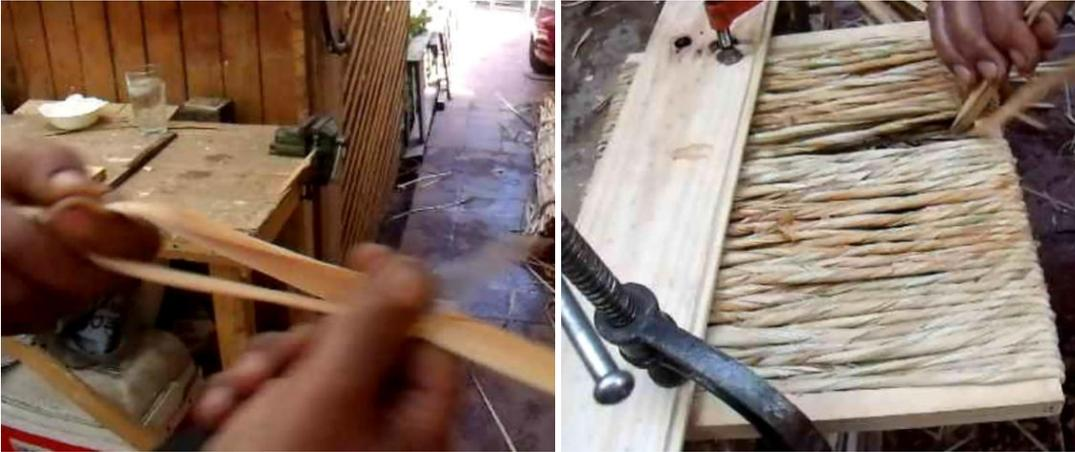
Ilustración 15. Desfibrado de Totora. Elaboración propia
