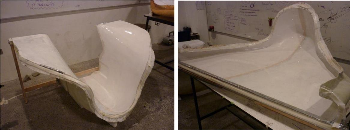
Ilustración 39. Moldes inferior y superior. Elaboración propia
