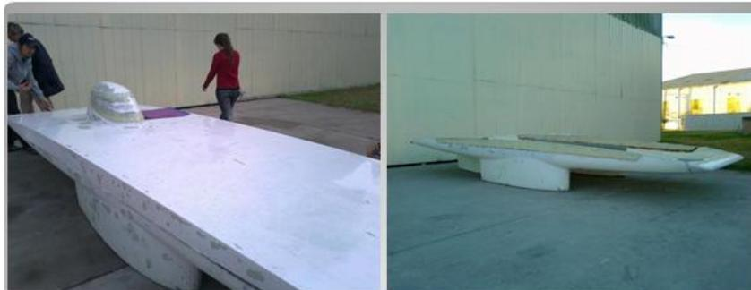
Las piezas del carenado se separan de los moldes, y se preparan con lija 80 a 220 en la superficie de Gelcoat, la cual sufre fracturas durante el proceso de desmolde, el tratamiento superficial en las piezas de compuestos se compone de una aplicación de masillas livianas de terminación con carga de microballons, para luego pasar a primer poliuretano y finalmente la pintura poliuretano.
