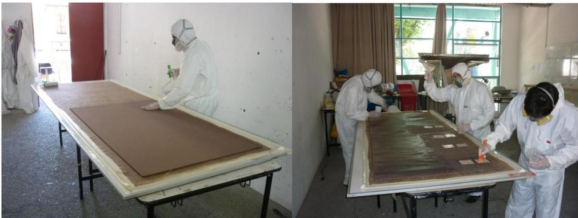
Figure 14. Laminación de Yute con Núcleo de klegecell. Elaboración propia
