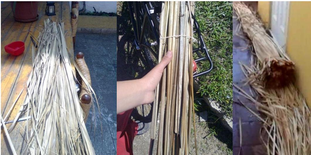
Ilustración 12. a) Fibra de Palma. b) Fibra de Pita. c) Fibra de Totora. Elaboración propia
