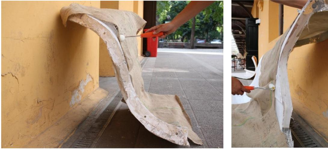
**Ilustración 44. Ángulos adecuados de laminación. Elaboración propia**
