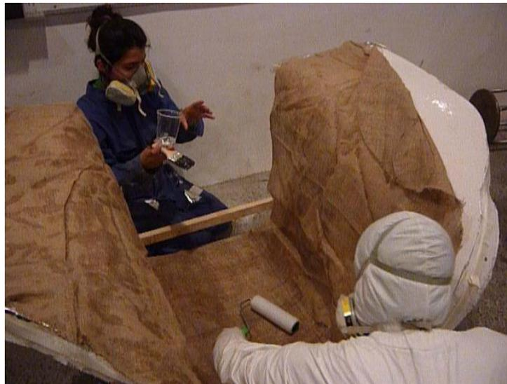
Ilustración 43. Laminación molde inferior. Elaboración propia
