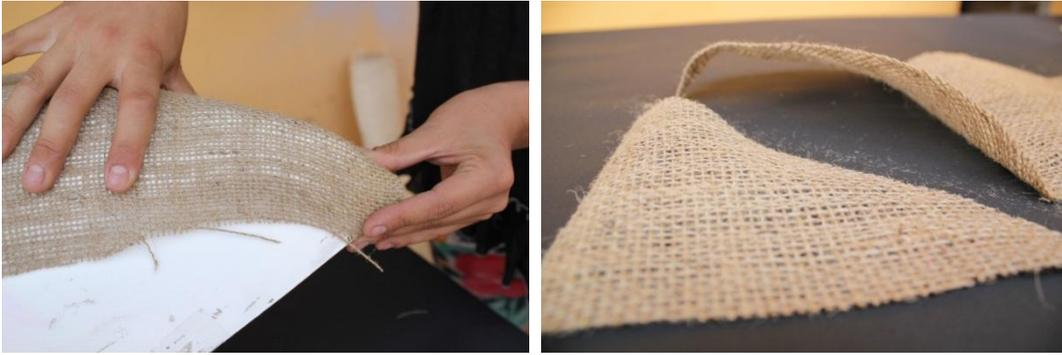
Ilustración 29. Adaptación a doble curvatura. Elaboración propia
