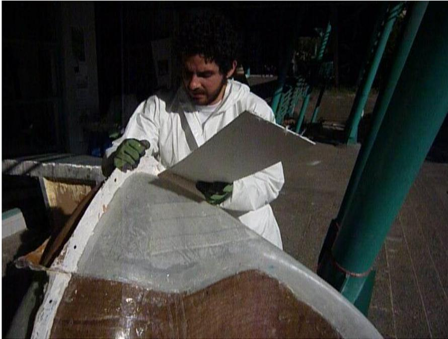
Durante el desmolde, no se producen retenciones, y el resultado es una fibra mixta que presenta variadas burbujas de aire en su superficie.
