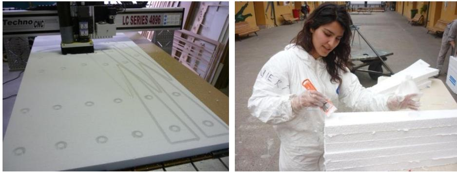
Figura 7. Maquinado Cnc del master. Elaboración propia
