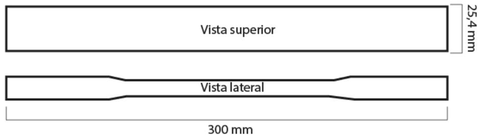
Ilustración 22. Dimensiones de las probetas. Elaboración propia
