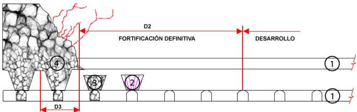
Figura 2.10: Secuencia operacional con Panel Caving convencional. (Modificado de Cavieres, 1999)
