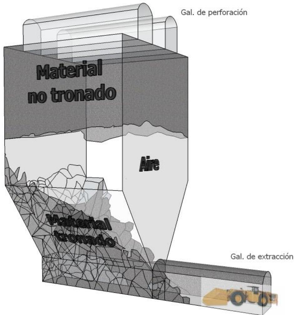
Ilustración 6: Esquema de extracción del material tronado.
