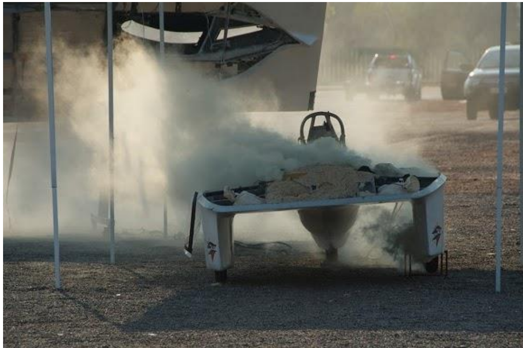
Figura 4.10: El Sikat II, de Team Solar Philippines, humeante al incendiarse su banco de baterías
