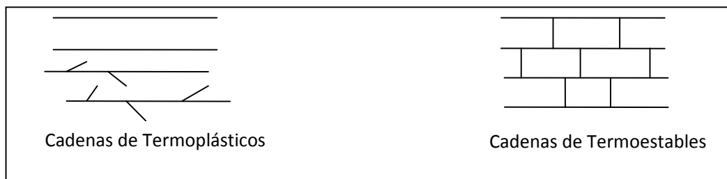
Figura 3: Cadenas moleculares de Polímeros Termoplásticos y Termoestables. Fuente: Introduction to Plastics Recycling [5].
