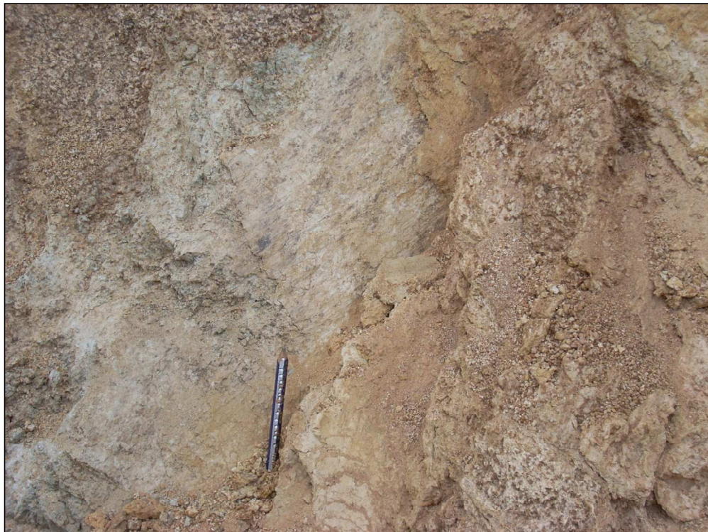
Fotografía 7.4.b. Detalle de falla mostrando estrías con dirección 46°S y evidencias de movimiento de tipo sinistral inverso. Fuente: Obtención propia
