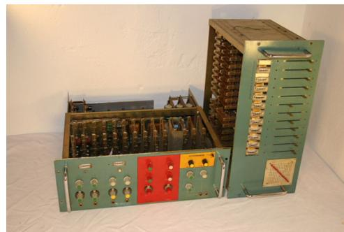
*Vocoder personalizado utilizado por Kraftwerk a principios de los 70's.*
