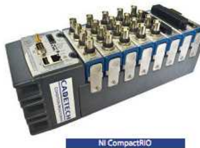
Ilustración 34: Equipo CompactRIO con módulos incluidos
