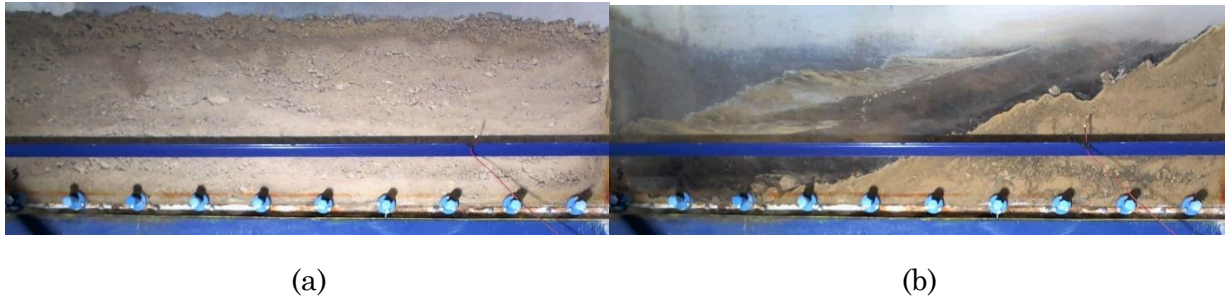
Figura 4-25: Densidad Máxima y pendiente 43°. En(a) altura del material antes de comenzar la experiencia. En (b) condición final de la muestra de suelo.
