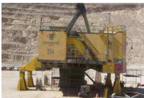
Figura N°26, Levante de pala 4100 XPB para cambio de corona de giro
