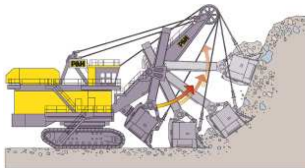
Figura N°22, Fase de excavación
