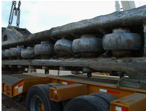
Figura N°53, Bastidor con daños en rodillos y elementos estructurales
