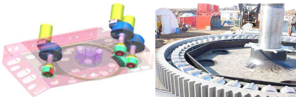
Figura N° 12, Sistema de giro pala P&H 4100 XPC
