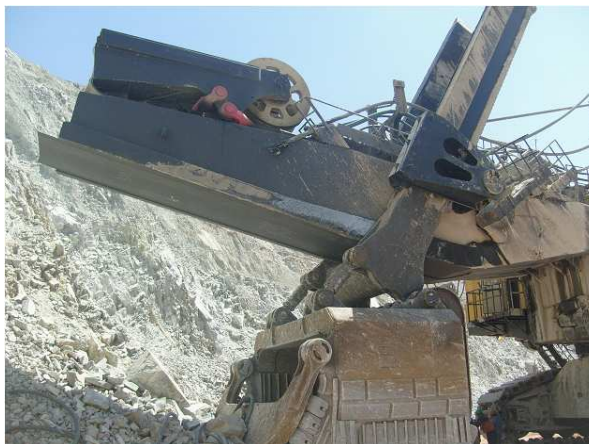
Figura N° 52, Falla catastrófica pluma 4100 XPB
