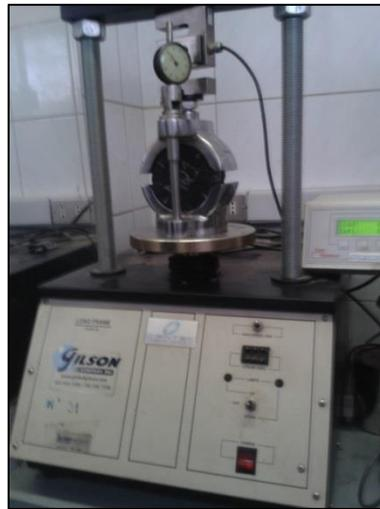
**Figura 3-2. Prensa Marshall y mordazas de carga.**
