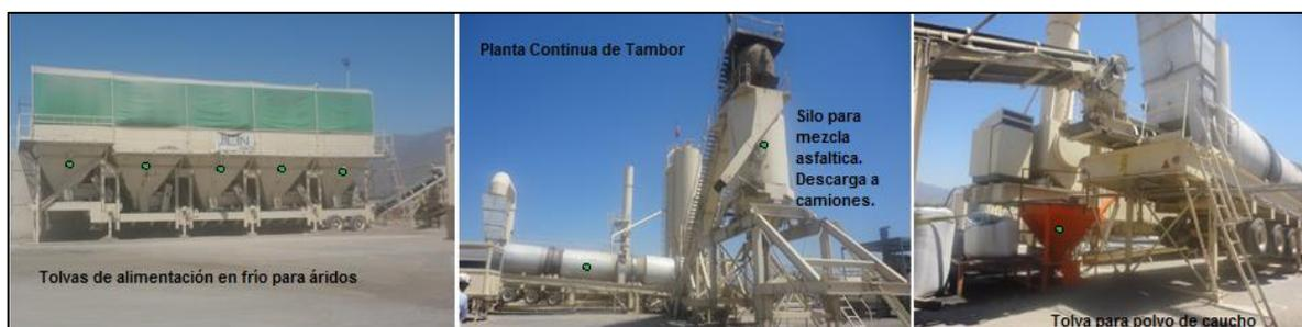
**Figura 4-46. Confección de la mezcla asfáltica con polvo de caucho en Planta.**
