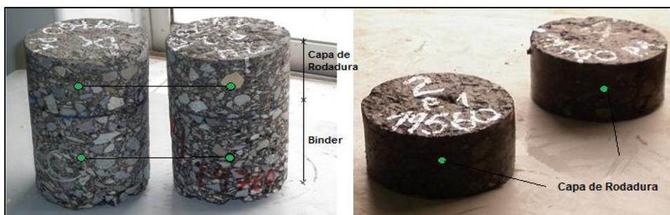
Figura 4-18. Testigos extraídos del pavimento (carpeta + binder).
