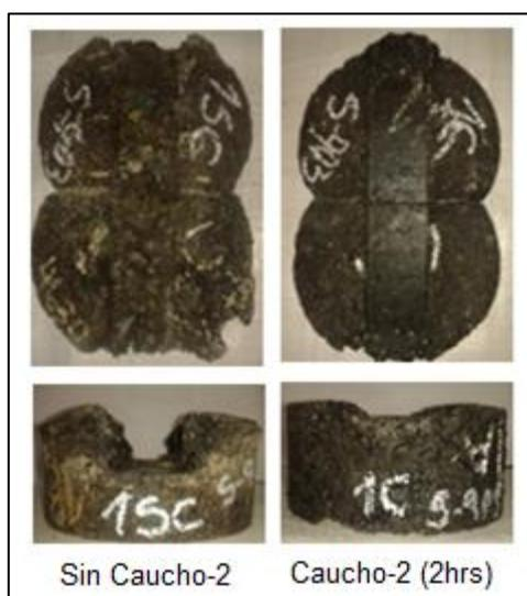
**Figura 4-45. Probetas ensayadas en la Rueda de Hamburgo.**
