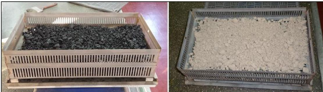
**Figura 3-12. Muestras de mezcla asfáltica inicial y masa residual de agregado (método de ignición).**
