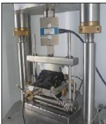
**Figura 3-7. Equipo de ensayo para determinación de módulo resiliente.**
