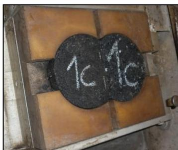
**Figura 3-10. Disposición en forma de “ocho” con probetas cilíndricas.**
