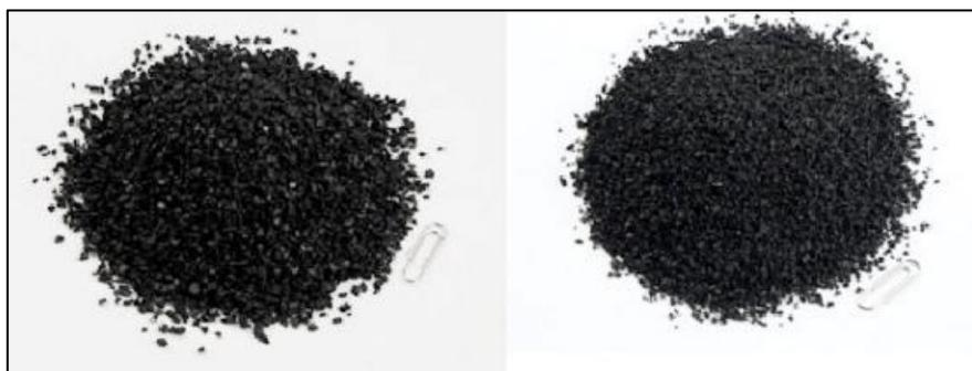
**Figura 2-6. Polvo de caucho de tamaño menor a 2mm (izq.) y 1mm (der.).**
