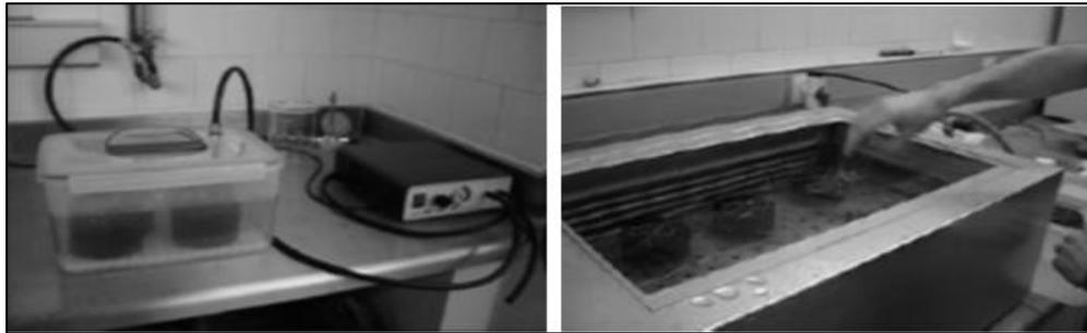
**Figura 3-5. Probetas en saturación al vacío y probetas en baño de agua.**
