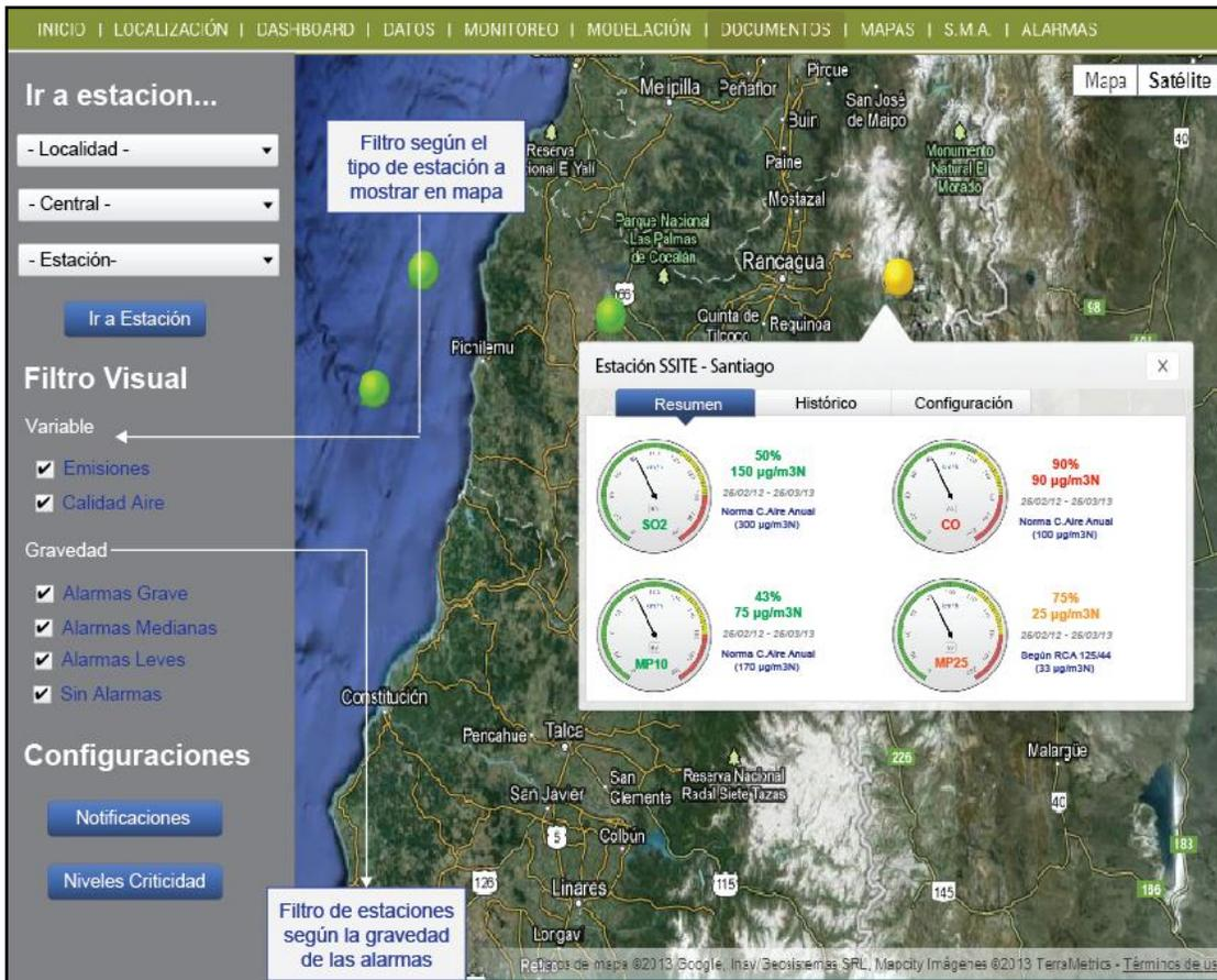
Ilustración 8. Vista geolocalizada de las estaciones de monitoreo con sus respectivas mediciones
