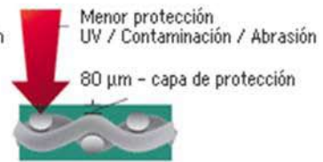
Menor protección UV / Contaminación / Abrasión 80 µm - capa de protección Tejido recubierto clásico 650 g/m 2
