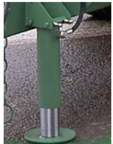
Imagen 53. Brazo hidráulico tipo utilizado para el apoyo en el terreno del volumen secundario.
