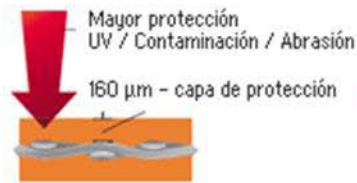
Mayor protección UV / Contaminación / Abrasión 160 µm - capa de protección Textil Précontraint® 502 590 g/m 2
