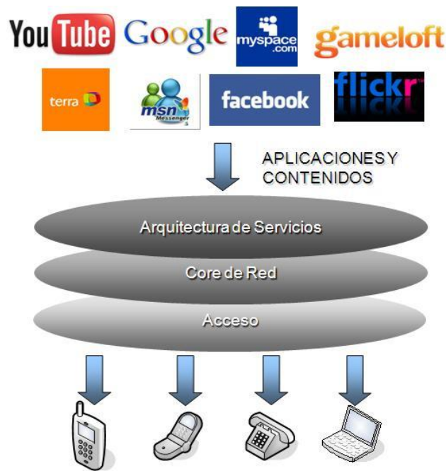
Figura 3.8: Arquitectura de prestación de servicios de un operador de telefonía
