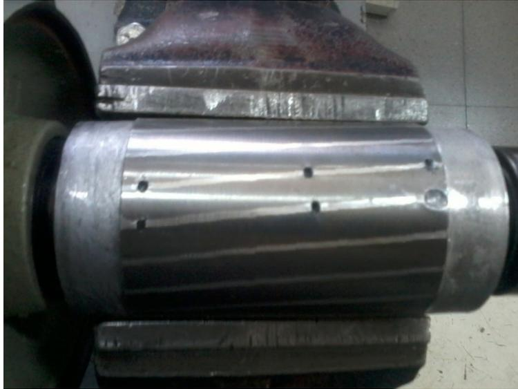
**Figura 38: Falla de barras del rotor del motor.**
