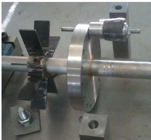
**Figura 29: Montaje de desbalance.**
