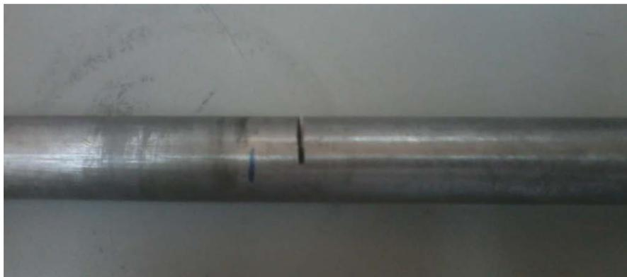
**Figura 33: Montaje de grieta de eje.**
