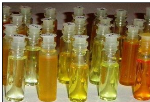
Figura 70: Combustibles líquidos obtenidos por Singh et al. (2013) de coloración similar a los producidos en este trabajo.
