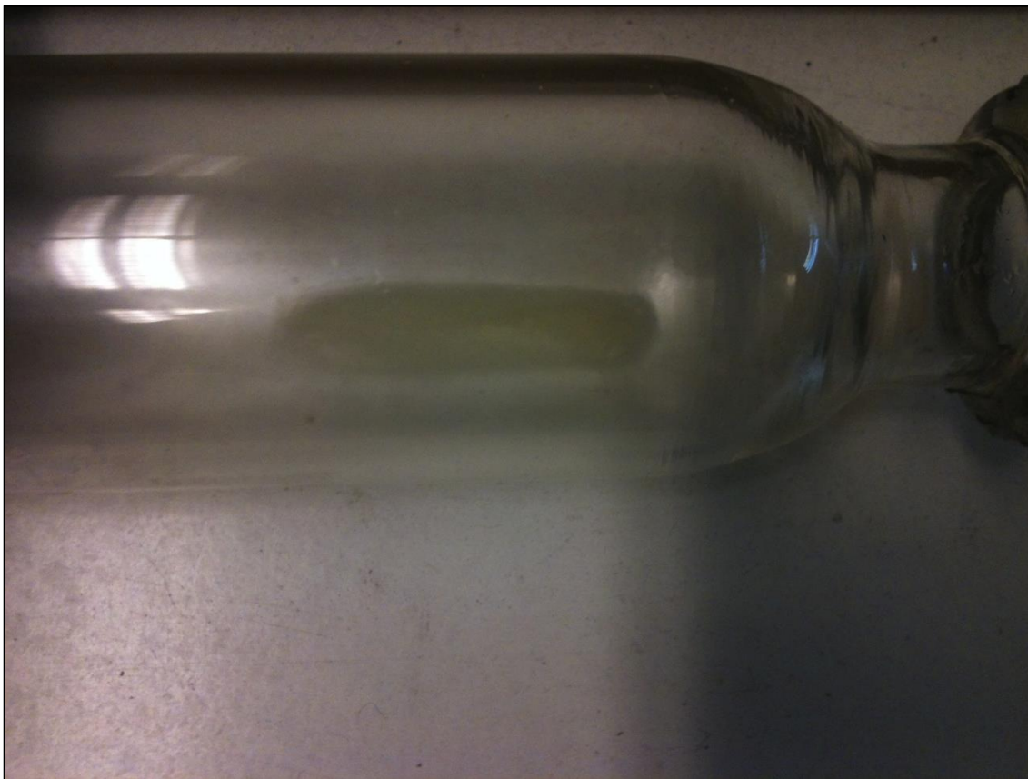
Figura 75: Fracción de ceras observadas en la trampa correspondiente tras remover los líquidos almacenados.
