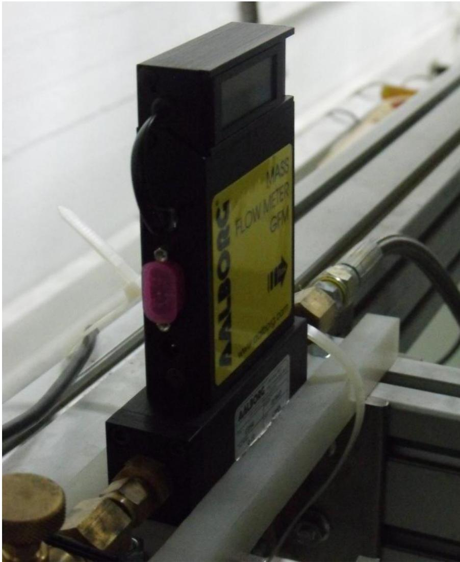
Figura 4.8: Flujómetro usado en este estudio.
