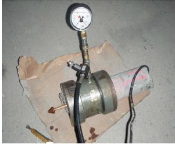
Figura 2-19. Ensayo Biaxial realizado al testigo sobre perforado.
