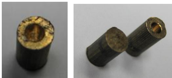
Figura 3.13 Probeta con la perforación donde se inserta la termocupla para registrar la evolución de temperatura.
