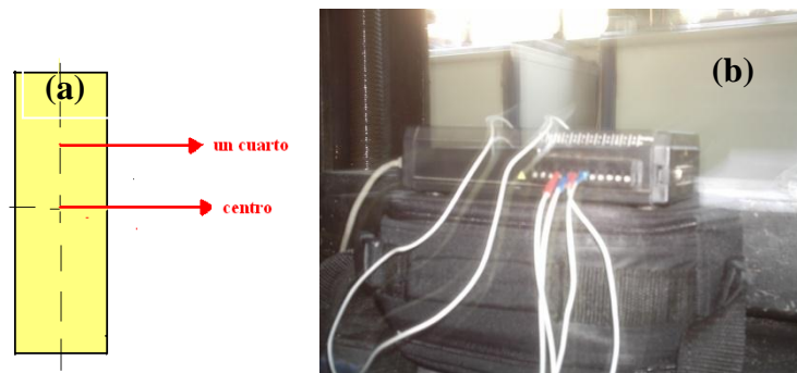
Figura 3.1 a) Ubicación de termopares en la probeta dentro de la zona de 25mm del extensómetro y 3,4 mm de diámetro. b) Interfaz DAQVIEW XL.
