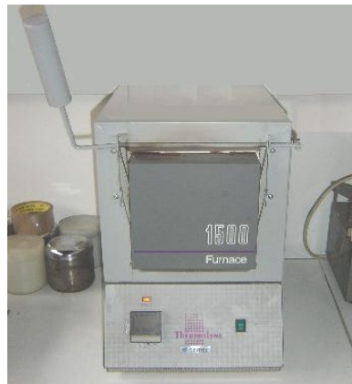
Figura 3.12 Mufla THERMOLYNE digital, utilizada en los tratamientos térmicos.
