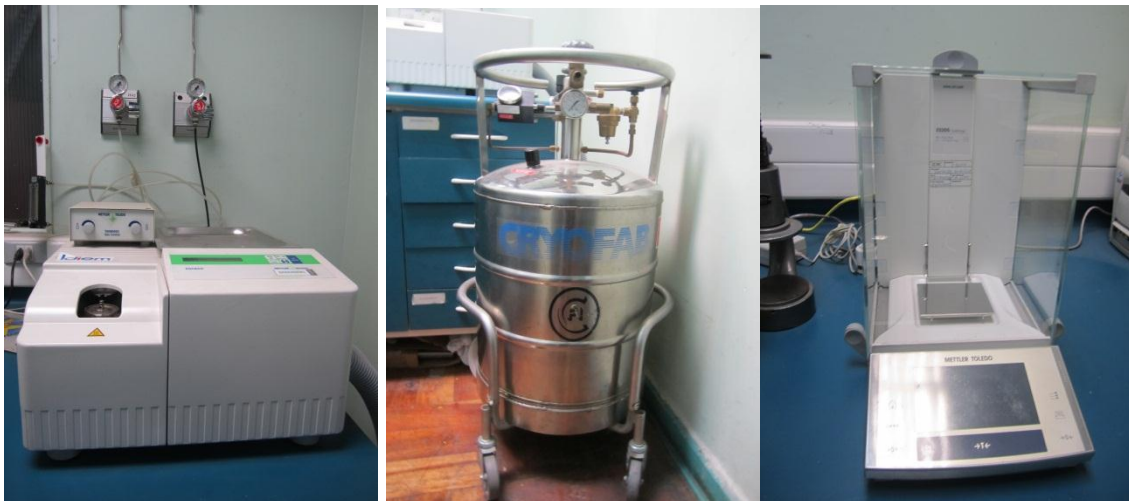
Figura 3.5 a) Equipo DSC modelo METTLER, b) balón que contiene nitrógeno líquido, c) balanza donde se pesa la muestra antes de ingresar al DSC.
