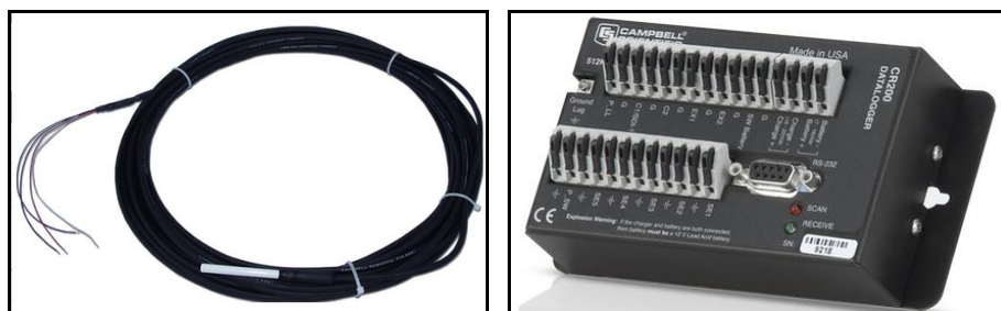
Figura 10. Termistores. Se muestra uno de los sensores de temperatura (fotografía a la izquierda) y el datalogger CR 200 CAMPBELL (fotografía a la derecha).
