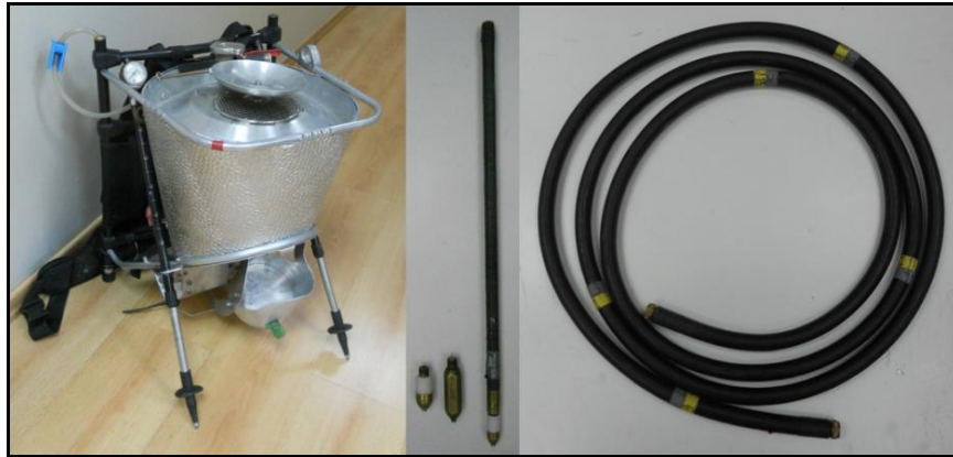
Figura 7. Heucke Ice Drill usado en los trabajos de campo (fotografía de la izquierda), seguido de la perforadora y sus cabezales (fotografía del centro) y la manguera conectora (fotografía de la derecha).
