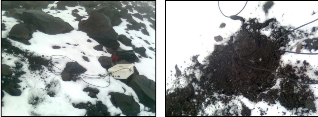
Figura 53. Mediciones de temperatura en suelo ubicadas al 100 m de la AWS (imagen de la izquierda) y termistores sepultados en arena (imagen de la derecha).
