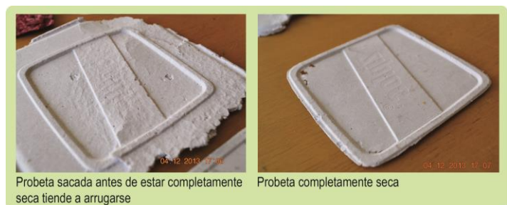
Figura 30: Diferencia entre probeta seca y probeta desmoldada antes de estar completamente seca. Elaboración propia.
