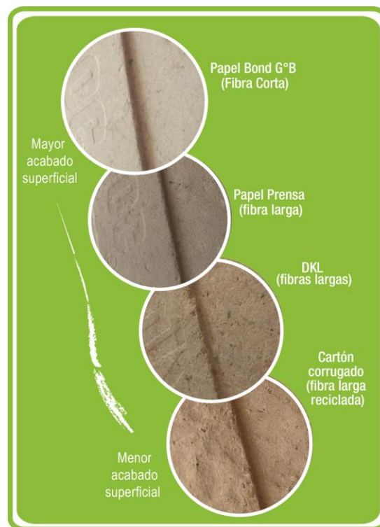
Figura 37: Comparación de capacidad de texturizado y terminación de altos y bajos relieves de la tipología de pulpas de papel moldeadas. Elaboración propia.
