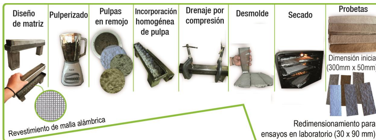
Figura 38: Proceso estandarizado para elaboración de probetas para ensayos mecánicos
