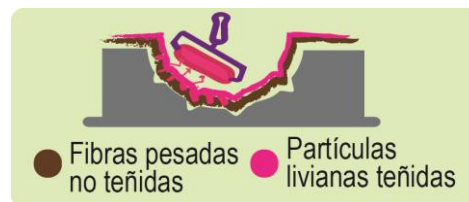
Figura 34: Estratificación de partículas según su peso. Elaboración propia.
