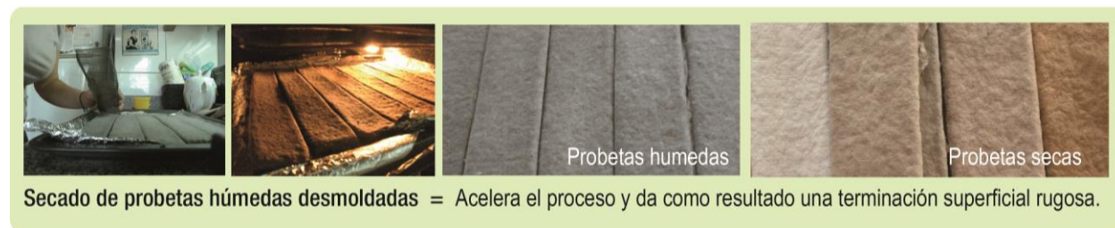
Figura 27: Método y resultados de secado de probetas desmoldadas en húmedo. Elaboración propia.
