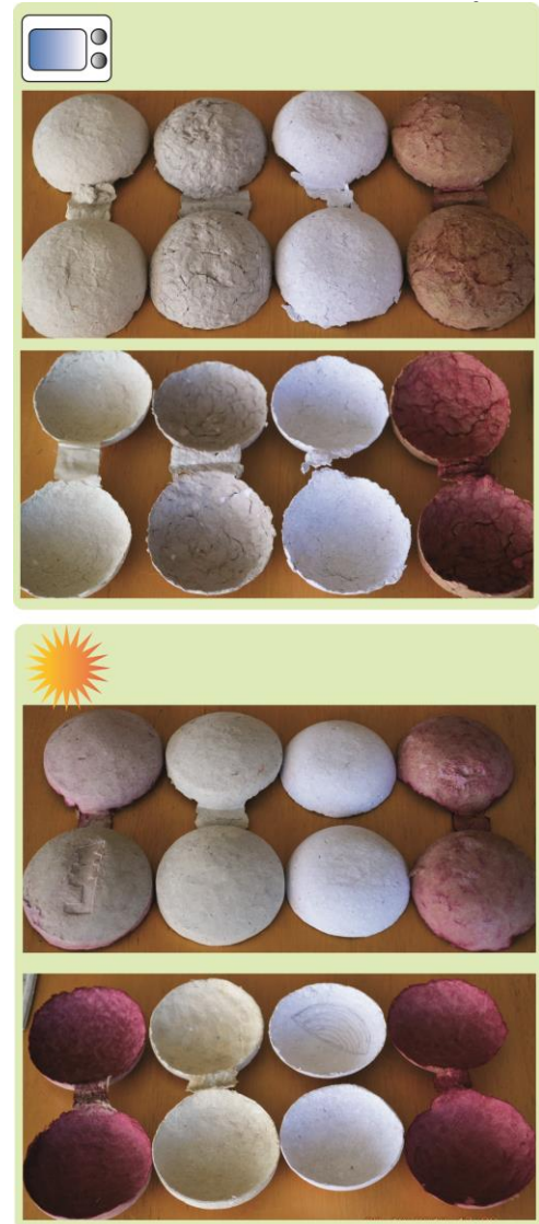
Figura 29: Diferencia de terminaciones en moldes secados en microondas y moldes secados a t° ambiente. Elaboración propia.
