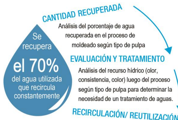
Figura 19: Cantidad de agua recuperada y reutilizada en el proceso de moldeado de pulpa industrial. Elaboración propia
