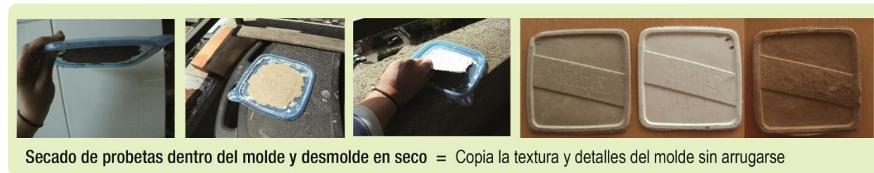
Figura 28 Método y resultados de secado de probetas desmoldadas en seco. Elaboración propia.
