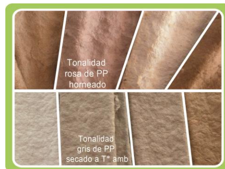
Figura 36: Gama de colores naturales adquiridos por la tipología de pulpas de papel. Elaboración propia
