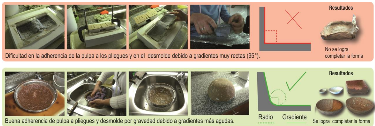
Figura 24: Gráfico de dificultades en el proceso de moldeado y determinación de soluciones. Elaboración propia
