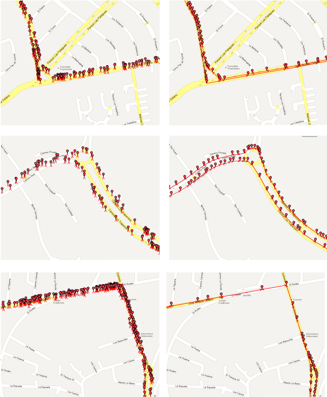
Figura 3.7: Ejemplo de puntos GPS que definen un recorrido particular. Izquierda puntos GPS, derecha recorrido que forman estos puntos
