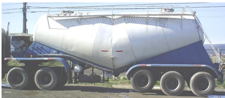
Fig 2 Silo para transportar y comercializar el cemento a granel
