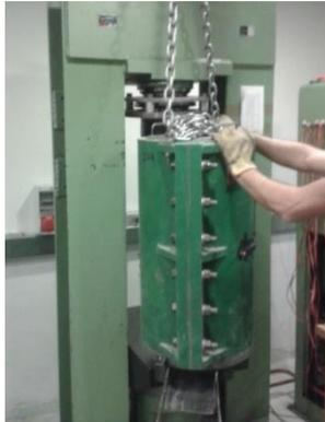
**Figura 23: Montaje de modelo físico bajo confinamiento**
