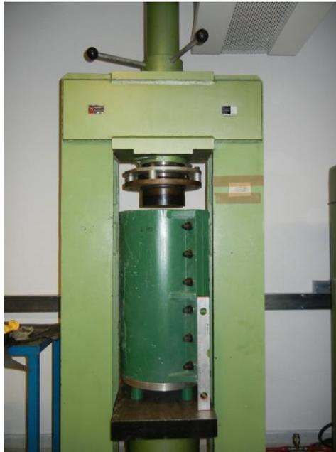
Figura 24: Prensa hidráulica con cilindro montado
