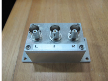
Figura 27. Multiplicador de señales (mixer).
