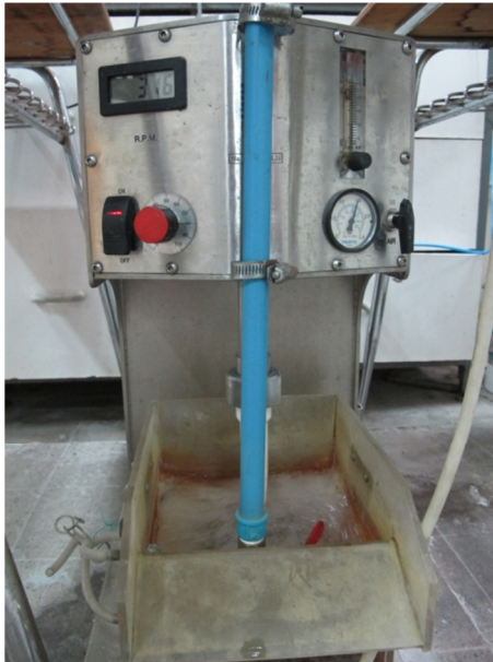
Figura 20. Celda de flotación laboratorio Labtech-ESSA.
