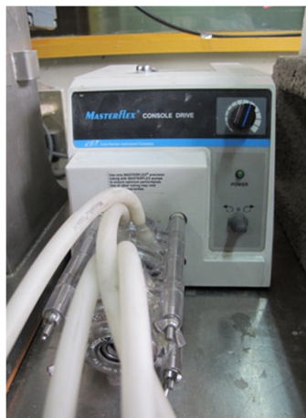
Figura 23. Bomba peristáltica con mangueras flexibles.
