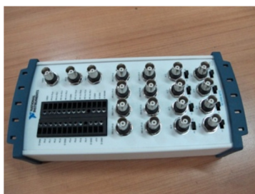
Figura 29. Tarjeta de adquisición de datos NI.
