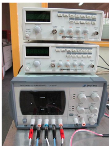
Figura 24. Fuente de poder y generados de funciones.
