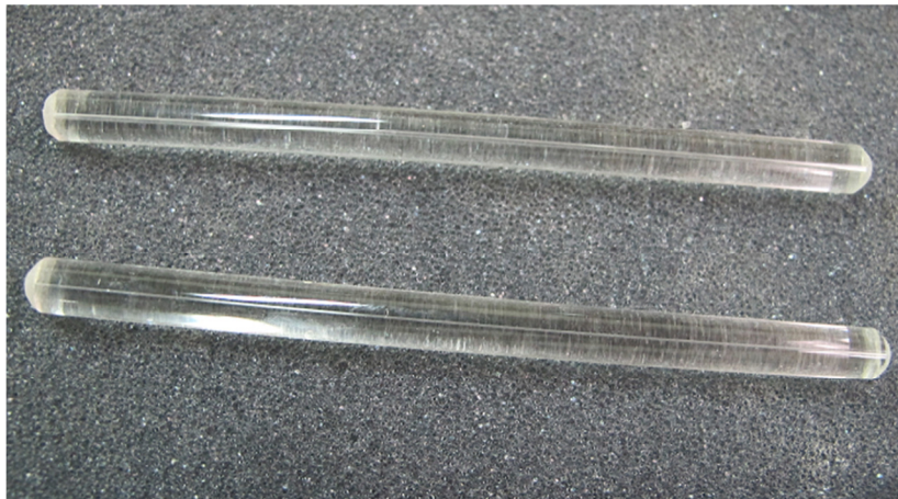
Figura 19. Tubos capilares utilizados para la generación de monotamaños.
