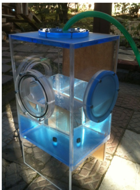
Figura 21. Cámara de medición de acrílico.
